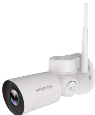
**Tipo** Telecamera HD 960p IP WI-FI/WIRED motorizzata PTZ da esterno con rilevamento di movimento. Compatibile ONVIF
