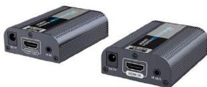
Estensore di segnale HDMI su cavo Ethernet (cat. 6) per trasferire il segnale HD 4K x 2K a massimo 30 m a frequenza 60 Hz o 60 m a frequenza 30 Hz senza perdita di segnale e qualità e ripetitore di telecomando.
