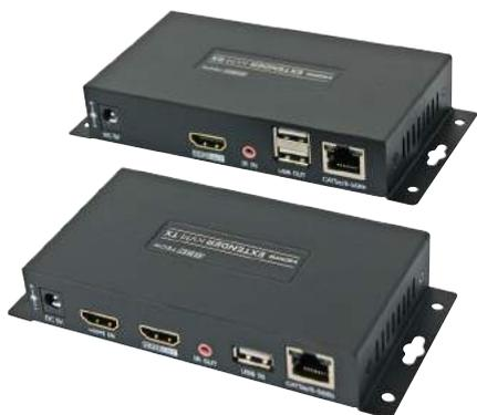
Estensore di segnale HDMI su cavo Ethernet (cat. 6) per trasferire il segnale HD 1080p a massimo 120 m senza perdita di segnale e qualità, con funzione KVM USB.
