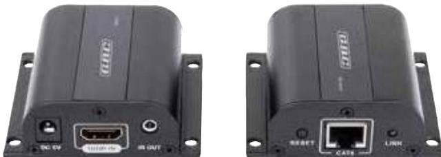
Kit con trasmettitore e ricevitore, amplifica il segnale HDMI fino a una distanza max di 50m su 1 singolo cavo di rete cat. 6 o 7. Può essere installato a cascata con uno splitter, e incorpora un ripetitore di telecomando IR.
