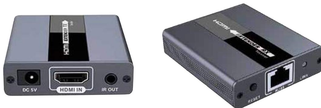
Amplifica il segnale HDMI, sensibile alla dispersione dovuta alla lunghezza dei cavi e lo trasferisce ad una distanza massima di 120m su cavo cat. 6 (100m su cavo cat.5e). Supporta risoluzioni Full HD 1080p. Può essere installato a cascata con uno splitter, e incorpora un ripetitore di telecomando IR.
