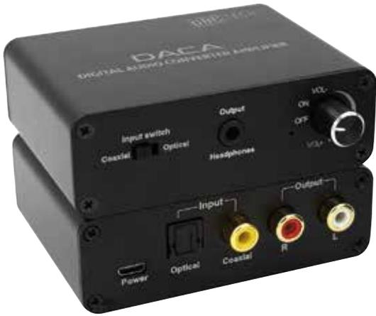
Convertitore audio Digitale/Analogico con amplificatore per cuffie (25mW x2 @ 16Ω, 22mW x2 @ 32Ω) e controllo volume. Ingressi Toslink e Coax, uscite RCA (non amplificata) per Home Theatre e 3,5mm stereo amplificata per cuffie. Frequenza di campionamento 32, 44.1, 48, 96 e 192KHz.
