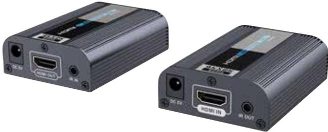
Amplifica il segnale HDMI, sensibile alla dispersione dovuta alla lunghezza dei cavi e lo trasferisce ad una distanza massima di 30m con risoluzione 4K@60Hz su cavo cat. 6 (60m per 4K@30Hz). Può essere installato a cascata con uno splitter, e incorpora un ripetitore di telecomando IR.
