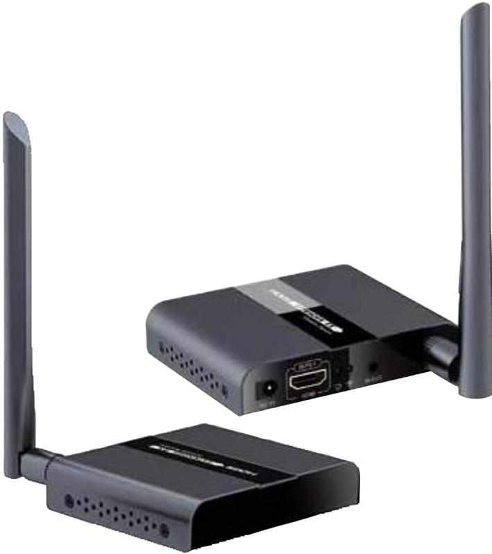
Amplifica il segnale HDMI senza fili ad una distanza massima di 50m (N.B.: senza ostacoli). Supporta Full HD 1080p; la frequenza wireless 5,8GHz migliora la qualità del segnale ed evita interferenze con altri apparati. Ideale per inviare il segnale HD in una stanza diversa da quella della sorgente. Incorpora un ripetitore di telecomando.
