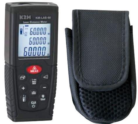
\* Utilizzare una piastra target per aumentare il range di misurazione durante la luce del giorno o se il target ha scarse proprietà di riflessione!
