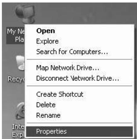
**Passo 2** – Fare clic con il tasto destro sull'icona di un'interfaccia di rete o dell'adattatore di rete wireless e scegliere **Proprietà** (N.B. In modalità Client, i computer possono collegarsi al WF300 solo tramite un cavo Ethernet.)
