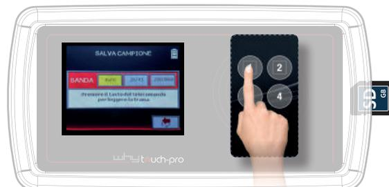
Rilasciare il tasto del radiocomando quando viene scritto sul display. Traccia acquisita correttamente
