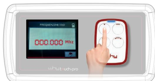
Leggere sul display la frequenza del radiocomando
