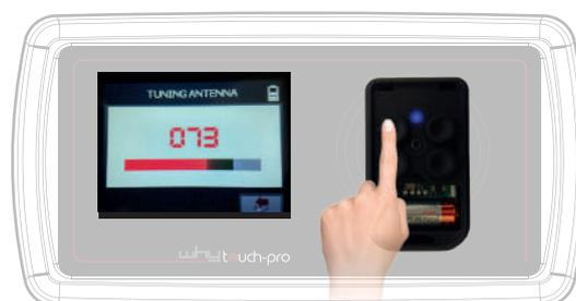
Tarare attraverso l'ausilio di un cacciavite ceramico la "potenza" dei radiocomandi quarzati fino a farle raggiungere il valore più alto possibile
